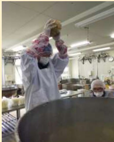
ミンチにかけた材料を団子状に丸め、大型仕込み容器に空気が入らないよう投げ込む
