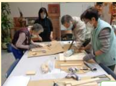
指金を使って台の固定位置を決める
