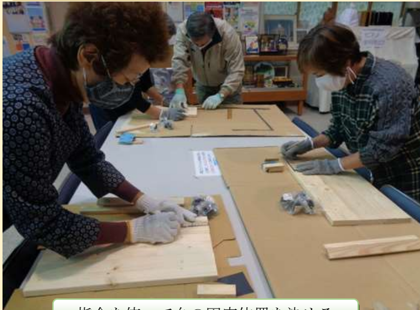
指金を使って台の固定位置を決める
